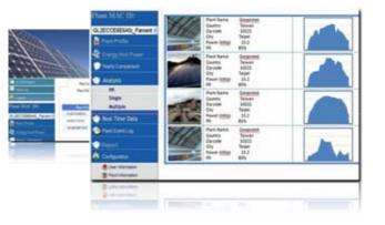
對系統業者來說,需要一個能夠同時管理所安裝過的太陽能電站網站平台,在輸入帳號及密碼登入後,GEOSOLAR PORTAL隨即列出所有太陽能電站的發電情況,系統業者可以輕易的查詢每個電站的運作狀況,若發生異常,可以透過事件紀錄及確認每個站的發電報表來檢測。每台GEOPROTEK的監測產品,在出廠前會將資料指定給系統業者,在產品註冊過後,系統業者只需要登入專屬的帳號密碼即可。系統使用者也可以透過此平台檢視他們的太陽能發電數據及資訊,確保系統運作在最佳狀態。
