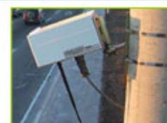
RTMS (遠端交通微波檢測器)
